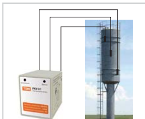
Автоматический контроль уровня воды в водонапорной башне.
